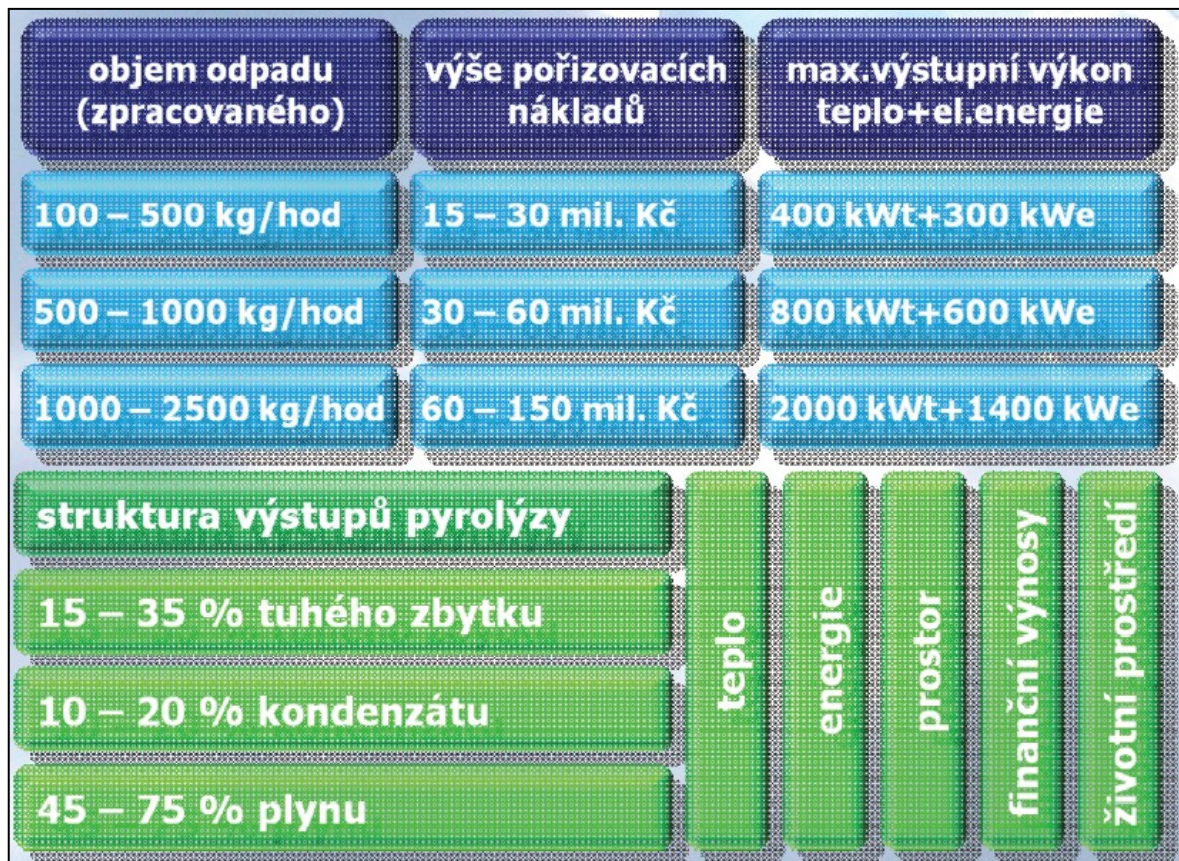
Obrázek 7: Příklad investičního celku na zpracování 500, 1 000 a 2 500 kg tříděného odpadu za hodinu.[29]
