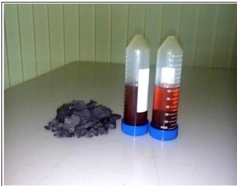
Obrázek 3: Pevný zbytek a kapalný produkt termických procesů.[12]
